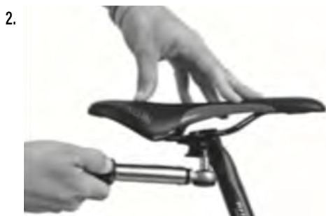
Aperte ambos os parafusos de forma progressiva e alternada, nunca exceda o torque de travamento máximo permitido.
