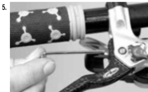
Configurações para a distância da alavanca do freio do guidão.
