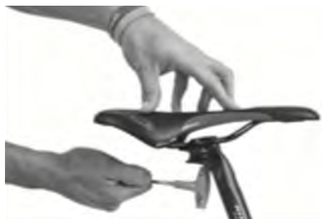
Afrouxe os dois parafusos aproximadamente duas a três voltas.
